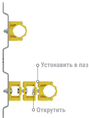
Рисунок 5. Установка дополнительного удлинителя.
