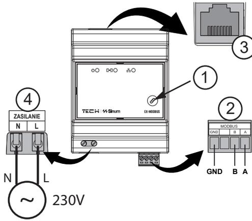
Extender EX-MODBUS je zařízení používané k rozšíření dosahu signálu periferních zařízení vůči ústřední Sinum. Připojuje se ke drátovým zařízením přes komunikační protokol Modbus a odesílá data do ústředny přes WiFi/LAN. Zařízení je určeno pro montáž na DIN lištně.
