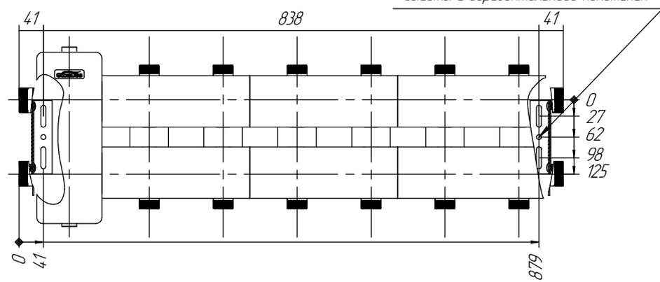
\* Для смены порядка "подачи" и "обратки" допускается перевернуть коллектор на 180° по горизонтальной оси
