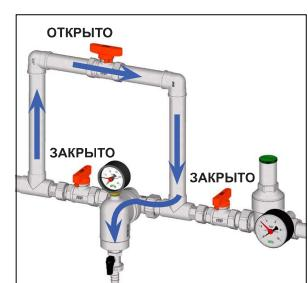
При необходимости более тщательной очистки картриджа нужно закрыть шаровые краны (Рис. 3), отвинтить нижнюю часть корпуса фильтра с помощью гаечного ключа и вытащить картридж (Рис. 4). После очистки картриджа установите его обратно и закройте вновь нижнюю часть фильтра (Рис.5).
