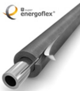
Трубки Energoflex® Super SK являются разновидностью трубок Energoflex® Super и отличаются наличием продольного разреза, на обе стороны которого предварительно нанесен клеевой слой. Это позволяет значительно упростить и ускорить установку теплоизоляционных конструкций, а также снизить расход клея. Применение самоклеящихся трубок дает возможность даже непрофессиональным изолировщикам выполнить аккуратный и качественный монтаж.
