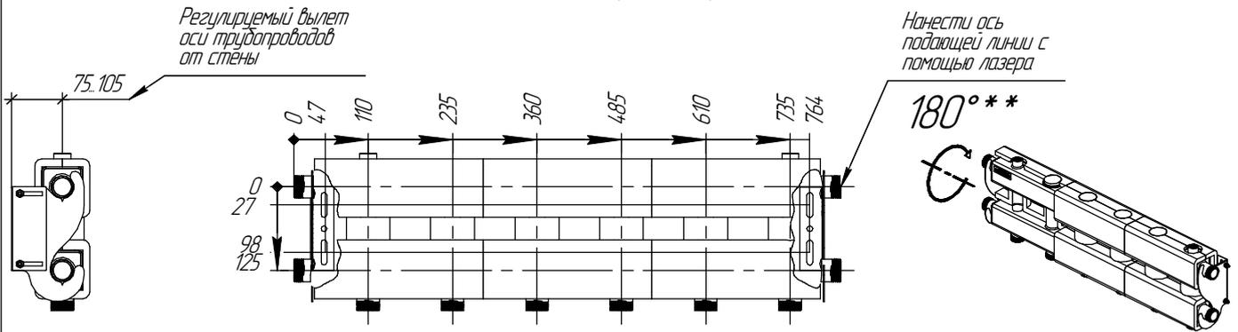
\*\* Для верхней подводки потребителей допускается перевернуть коллектор на 180° по горизонтальной оси
