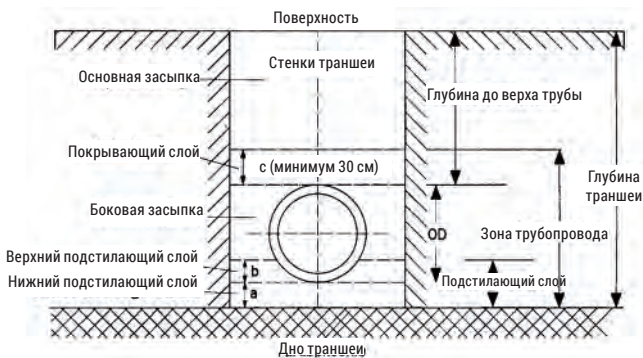
РИС. 3. УСТРОЙСТВО ТРАНШЕИ
